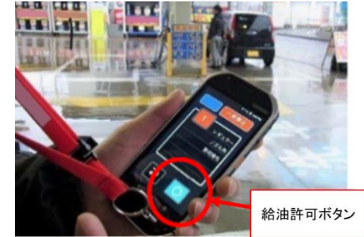
【給油取扱所におけるAIやIoT機器等の活用イメージ】 〔現在は従業員が安全を確認した上で給油許可を行っているところ、一定の条件下でAIが自動で給油許可〕
