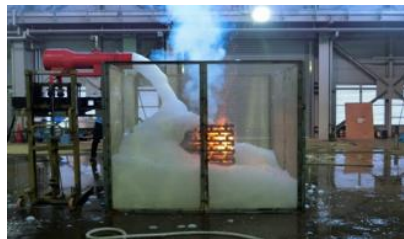
【泡消火実験の様子】
